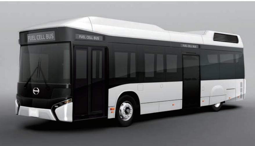
空気中の酸素と水素タンクの水素を化学反応させて発電し、その電気でモーターを動かして走る燃料電池バス。発電しても水しか排出しないのが最大のメリットだが、それ以外にも「音が静か」「加速がスムーズ」「災害時に電気を供給できる」など、いろいろなメリットがある。日野のブースでは燃料電池バスの仕組みをわかりやすく解説してくれる。その他にも、人々の暮らしを支え、豊かな未来に貢献する日野の最先端のクルマたちが勢揃いしている。
