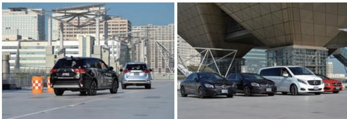
写真上：車外からもリモコンを使って「車庫だし」を自動で行える（デモは安全のためインストラクターが乗車）。写真下左：レーダーで車間を維持、カメラで前走車を追尾。コース上のパイロンをしっかりと避けて走る。写真下右：11月5日（木）まで三菱自動車、ホンダ、メルセデス・ベンツがデモンストレーションを実施。
