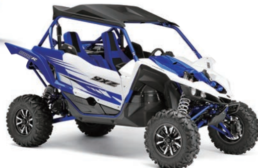
▶新開発の水冷3気筒998ccエンジンを採用した二人乗りピュアスポーツモデル「YZZ1000R」。荒地や砂漠でも高い走破性を見せる。
