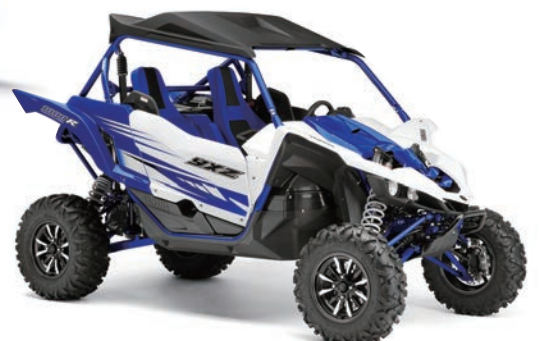
▶新開発の水冷3気筒998ccエンジンを採用した二人乗りピュアスポーツモデル「YZZ1000R」。荒地や砂漠でも高い走破性を見せる。
