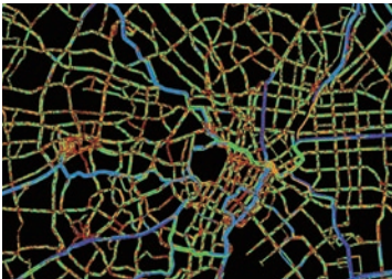
プローブ交通情報を解析、交差点の右折・左折の待ち時間がわかる。混雑の原因を分析し、緩和させる。
