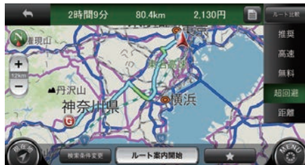
「カーナビタイム」と「NAVITIME ドライブサポーター」に採用された「超渋滞回避ルート」。渋滞予測とプローブ交通情報から、高速道路を乗り降りしたり、遠回りしても目的地に早く着くルート(下図)を探索する。
