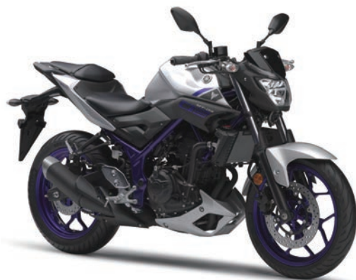
▲自由自在に走れる、と人気の高いMTシリーズの「MT-03」(エムティ ゼロスリー)。軽量コンパクトな、水冷・直列2気筒エンジンを搭載。
